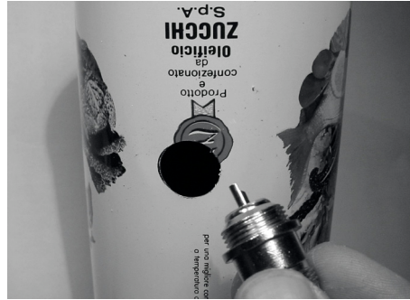
Figura 4.37: Taladre cuidadosamente un agujero piloto, luego use una mecha más grande para terminar el trabajo.
