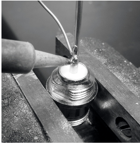
Figura 4.39: Suelde el alambre a la copa dorada en el conector N.
