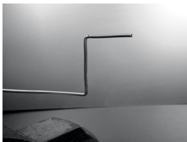
Figura 4.17: Doblar el alambre en forma de "Z".
